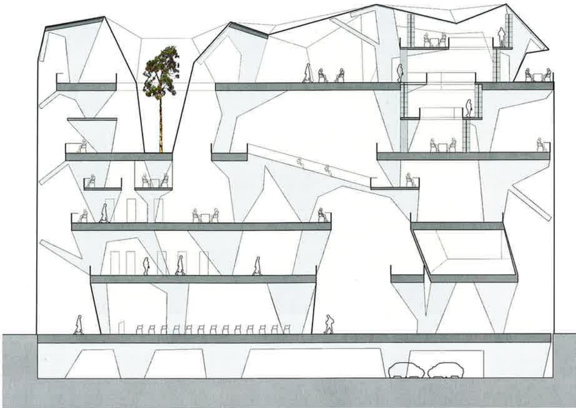
Konstruksjonen på innsiden, men synlig. Snitt gjennom konkurranseforslaget til TEAM 3 for Deichmanske bibliotek i Bjørvika, 2009. The structure is on the inside, but still exposed. Section from the proposal by TEAM 3 for the Deichmanske Library in Oslo, 2009.
